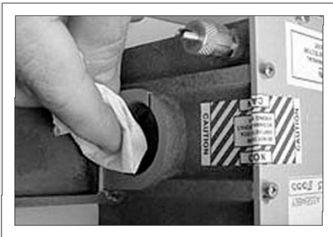
图 7-54 清洗 IR 光具座组件的蓝宝石窗
